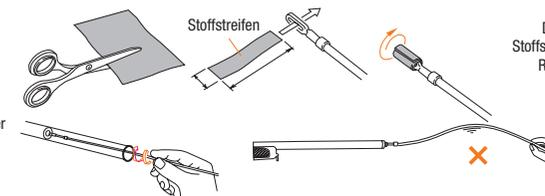
Drehen Sie den Stoffstreifen um den Reinigungsstab.
